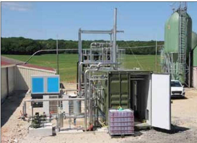
*Um eine wirkungsvolle Aufbereitung des Biogases zu garantieren, hat sich der deutsche Anlagenhersteller WELTEC BIOPOWER für eine flexible und kompakte Membrantechnik entschieden.*
